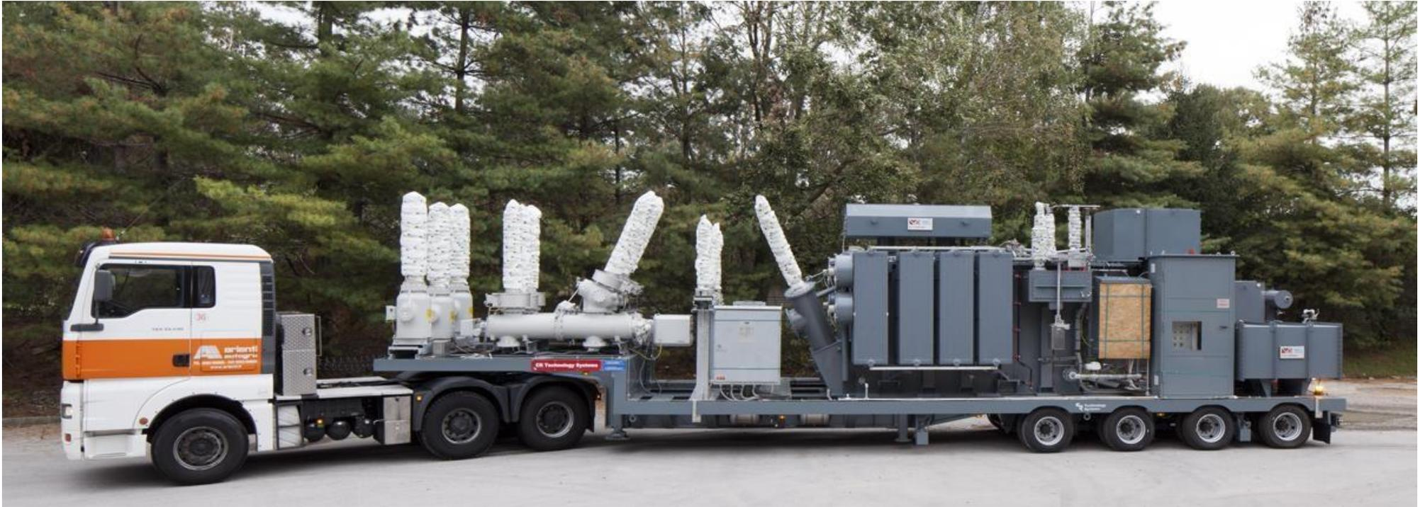
Solución ideal para la construcción de una o más bahías de línea o transformación, en forma transportable: los componentes se instalan en semirremolques o en basamientos “skid”.
